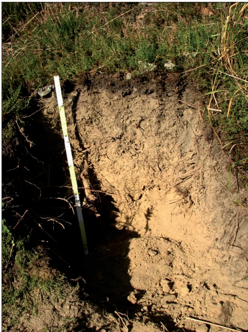
Obr. 3: Pedologická sonda, úrodný pôdny horizont s hrúbkou 10 cm. Fig. 3: Pedological probe, fertile soil layer with a thickness of 10 cm.
